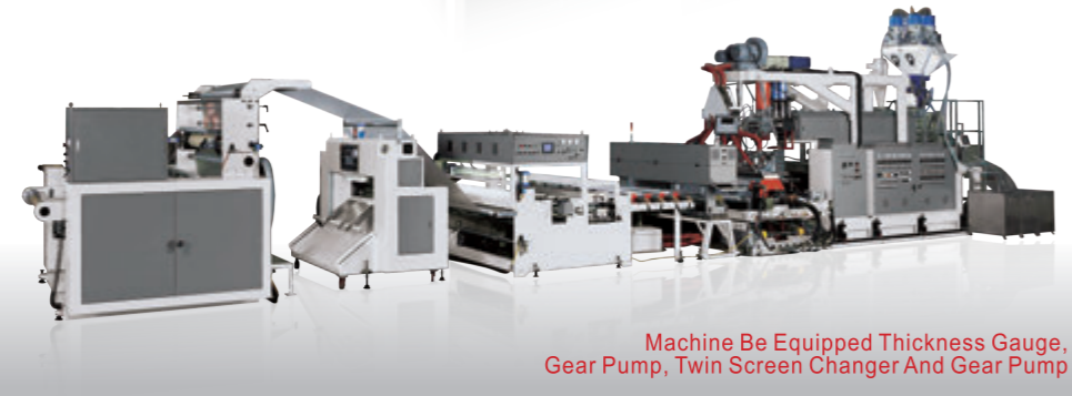
MGB-PPF-1000 Üçlü Manifold P.P Köpük Levha Ekstrüzyon Hattı
