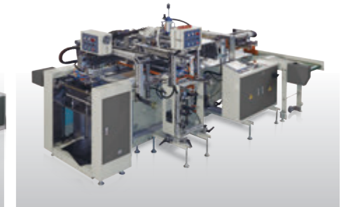
MGA-68F-550A Kağıt Yerleştirme ve Cep etiketleme Makinesi
