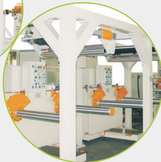
Tipo a sbalzo per bobine con diametro max. 800 mm., i due assi sono motorizzati indipendenti e corredati di un sistema molto pratico per l'espulsione della bobina.
